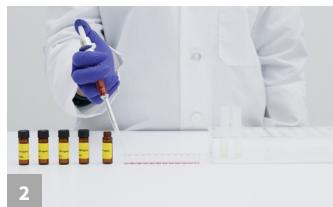
Agregue 100 µl de controles y muestras extraídas en el pocillo de mezcla marcado con rojo. Asegúrese de que los controles estén en el orden correcto según las instrucciones del kit.
