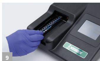
Limpie el fondo de los micropocillos con un paño seco y luego realice la lectura en un lector de micropocillos con un filtro de 650 nm.
