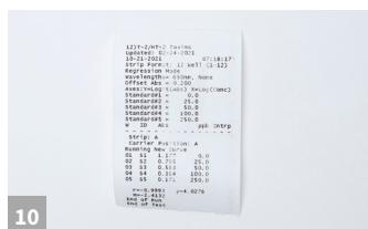
Para que se considere válido, el resultado se debe leer con un coeficiente por encima de 0,980. Debe diluir y volver a probar los resultados de la muestra por encima de 250 ppb. Se deben informar los resultados por debajo del límite de cuantificación como <25 ppb.
