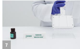
Transfiera (con el pipeteador de 12 canales) 100 µl de sustrato del reservorio para reactivos a los pocillos con anticuerpos. Incube a temperatura ambiente durante 5 minutos, deslizando la gradilla para micropocillos hacia atrás y hacia delante suavemente durante los primeros 20 segundos.
