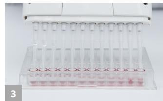
Mezcle bien, luego transfiera (con la pipeta de 12 canales) 100 µl en los pocillos con anticuerpos transparentes. Incube a temperatura ambiente durante 5 minutos, deslizando la gradilla para micropocillos hacia atrás y hacia delante suavemente durante los primeros 20 segundos.
