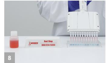
Transfiera (con un pipeteador de 12 canales) 100 µl de solución Red Stop del reservorio para reactivos en los pocillos con anticuerpos y mezcle deslizando hacia atrás y hacia delante sobre una superficie plana.
